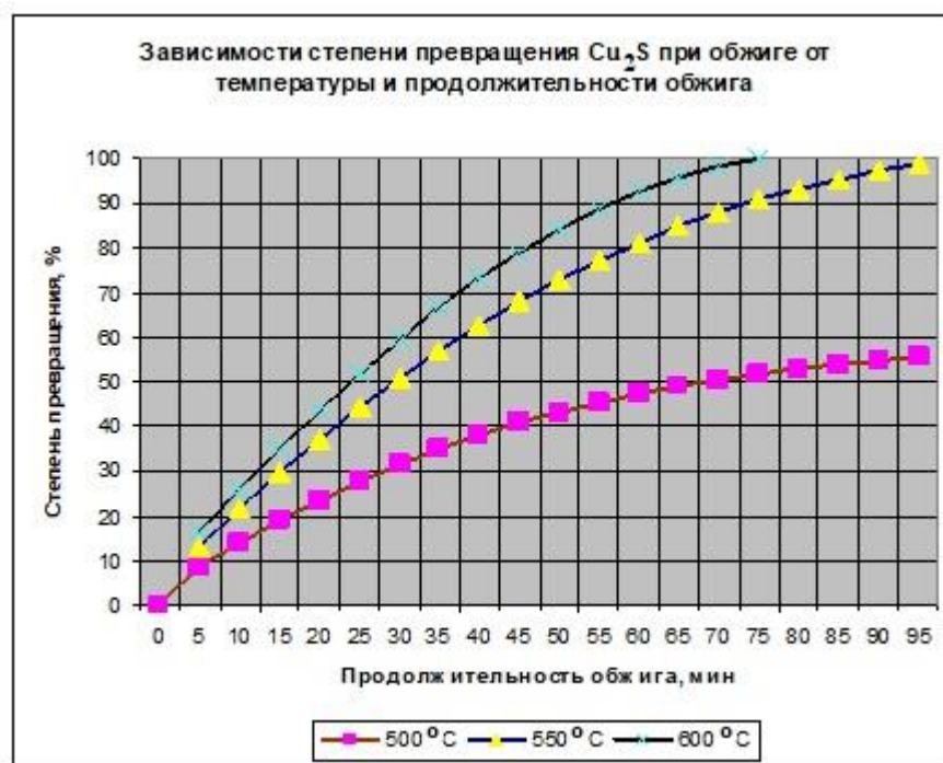
Рисунок 5.4 - Зависимости степени обжига сульфида меди от температуры и продолжительности процесса в вибро-пульсирующем слое
