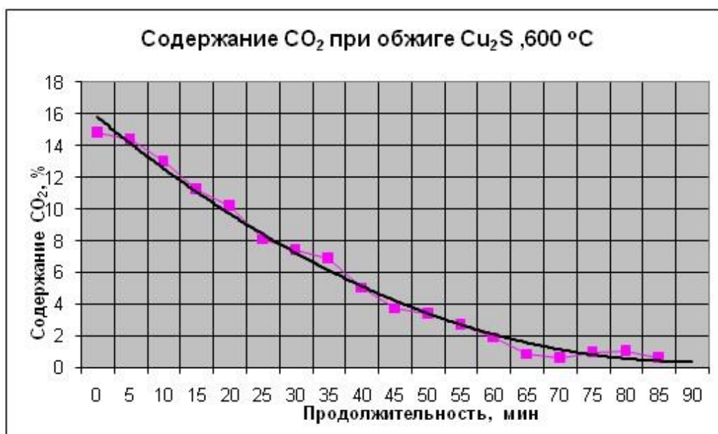
Рисунок 5.3 - Содержание \text{CO}_2 в газах реактора при обжиге сульфида меди, 600 °C
